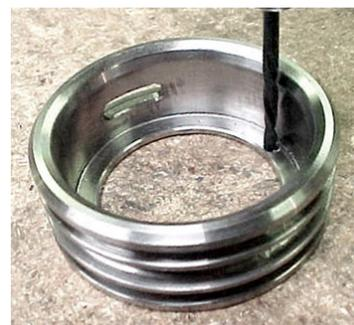
Passo 2: Riposizionare l'anello nella scatola cambio con il foro allineato. Il foro appena praticato deve essere in posizione "Ore 6". Rimuovere con cura i trucioli metallici.
