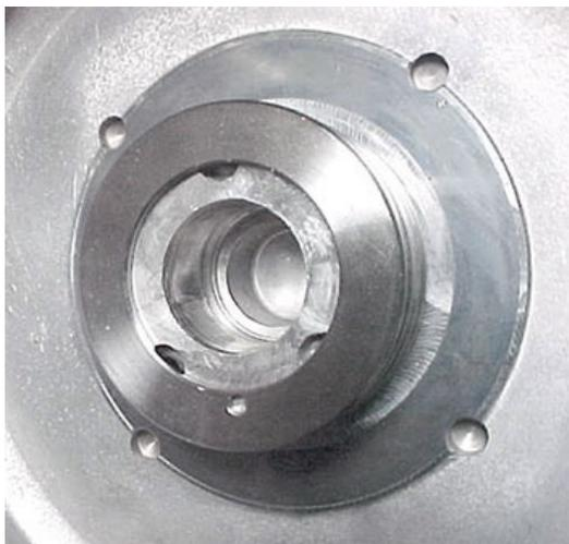
Problema: Questo perno è alloggiato in una guarnizione di tenuta ad anello nella quale è posta una bronzina che, prendendo a ruotare su se stessa per l'usura, tende a rovinare la scatola del cambio.
